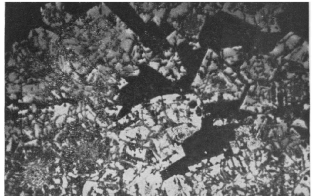
FIG. 1. — Fragment de l'échantillon examiné au microscope métallographique polarisant. L.P. x 500. Au milieu de l'argile on remarque les formes cristallines de la pyrite et les microorganismes.
